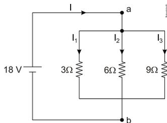
Desprezando-se as resistências dos fios de ligação, o valor da corrente em cada resistor é
