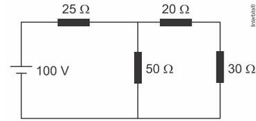
A figura acima representa um circuito elétrico constituído de uma fonte de tensão contínua de  $100 \text{ V}$  alimentando quatro resistores. Pode-se afirmar que a tensão elétrica nas extremidades do resistor de resistência elétrica  $30 \Omega$  vale
